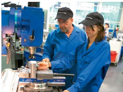
Maschinen- und Anlagenführer/-innen richten Fertigungsmaschinen und -anlagen ein, nehmen sie in Betrieb und bedienen sie. Sie rüsten die Maschinen auch um und halten sie instand.
